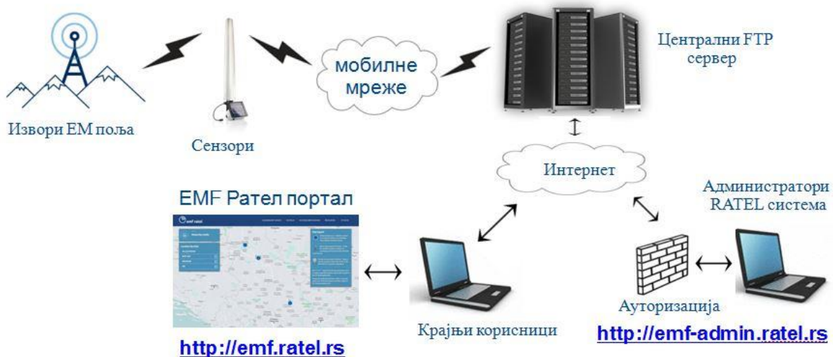
Слика 6. Архитектура система за праћење нивоа електромагнетског поља
