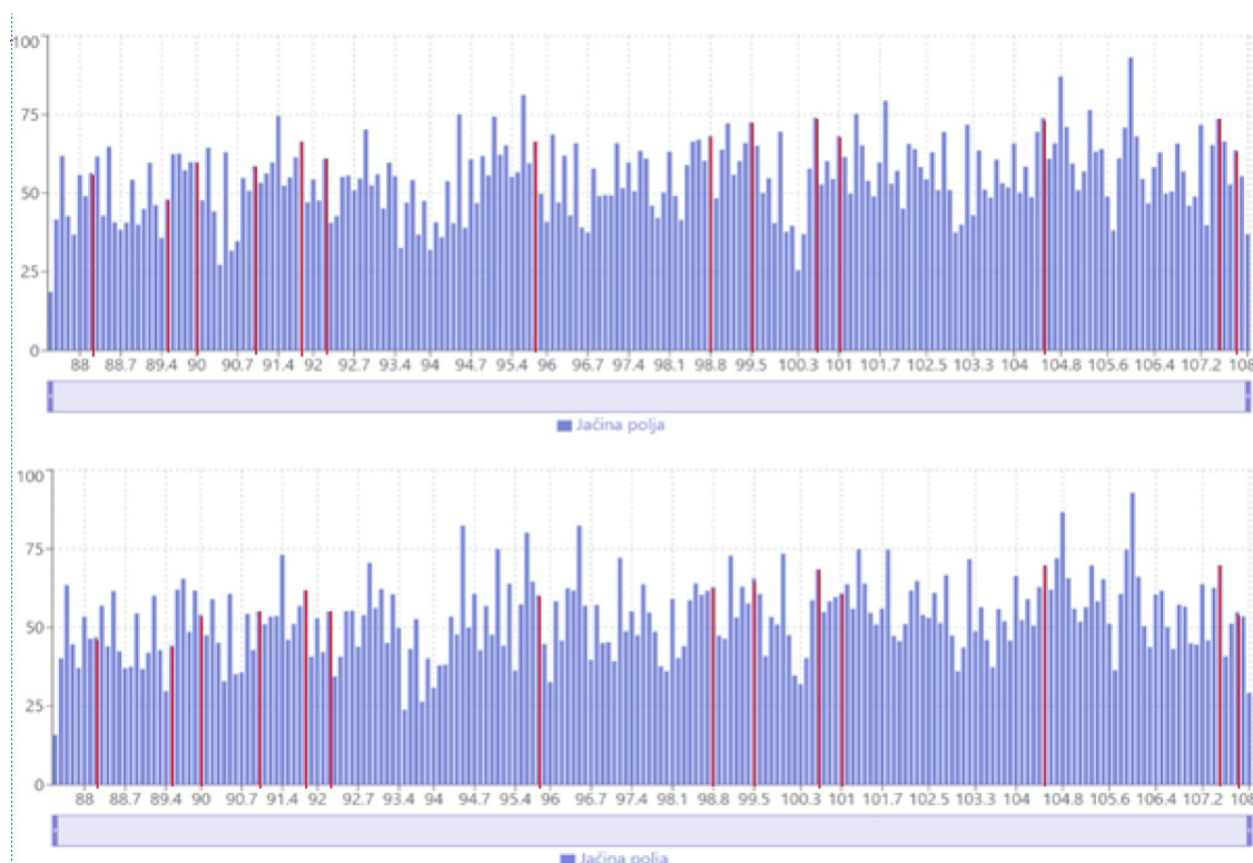
Slika 5.1 - Poređenje nivoa jačine električnog polja (u dBμV/m) pre kontrole (gornji grafik) i posle usklađivanja rada FM radio-stanice sa izdatom dozvolom (donji grafik). Napomena: Crvenom bojom su označena merenja za kontrolisanih 14 FM radio-stanica u Novom Sadu.
