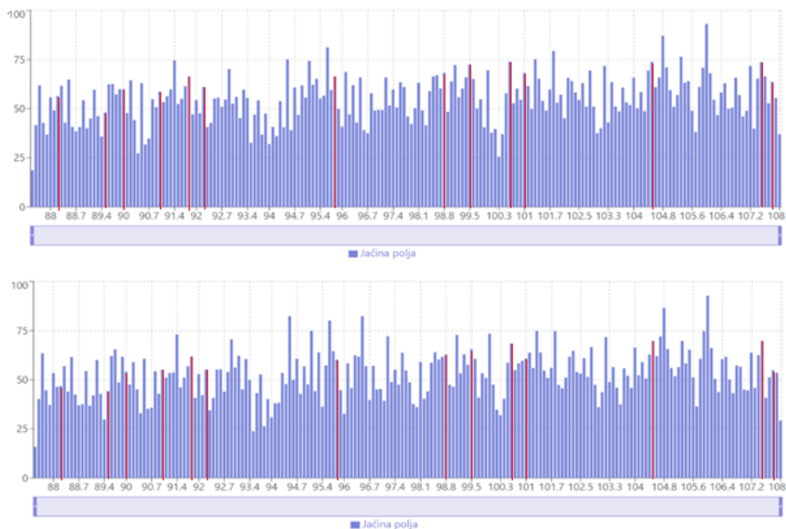
Слика 3. Поређење нивоа јачине ел.поља пре контроле (горњи график) и после усклађивања рада радио-станице по дозволи (доњи график)
