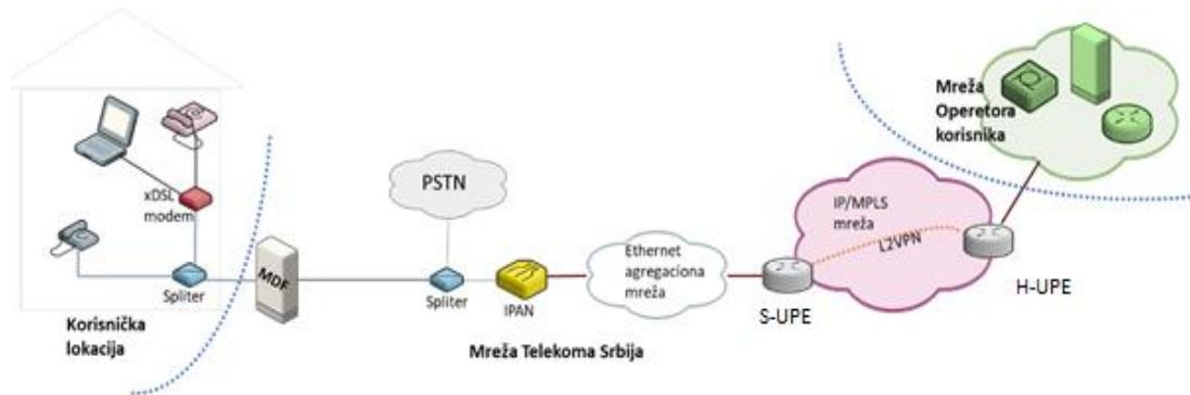
Na prvom segmentu, xDSL modem – IPAN, definiše se jedinstveni V-PVC 8/36 za voice za pristup preko ADSL tehnologije, odnosno VLAN ID 100 za voice ATA i 101 za voice (bridged mode) za pristup preko VDSL tehnologije. Operator korisnik konfiguriše V-PVC odnosno user VLAN na xDSL modemu, a Telekom Srbija konfiguriše IPAN. Na strani IPAN konfiguriše se odgovarajući dot1p (cos) bit kao i profil za ograničenje brzine.
